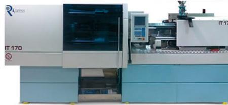
La serie IT, **5 modelli con forza di chiusura da 90 a 260 tonnellate**, si caratterizza sotto il profilo tecnologico per l'adozione di una pompa a portata variabile con controllo ad anello chiuso, elettrovalvole Rexroth per la gestione del circuito oleodinamico, trasduttori di posizione magnetostriativi CANbus, connessione esterna USB per la memorizzazione dei dati e presa Ethernet per il collegamento in rete. L'unità di controllo adotta uno schermo touch-screen e sistema operativo Linux.
